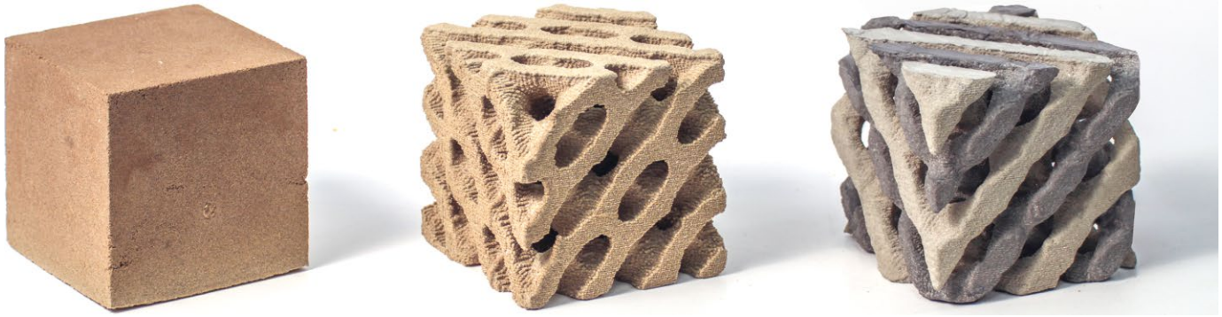
Bild 8 V.l.n.r.: Würfel aus Sand und Bindemittel, additiv gefertigte wasserlösliche Sandschalung, filigraner Probekörper, gegossen mit zwei Betonen in die additiv gefertigte Sandschalung From left to right: cube made of sand and binder, additively manufactured water-soluble sand formwork, filigree test specimen cast with two concretes in the additively manufactured water-soluble sand formwork
