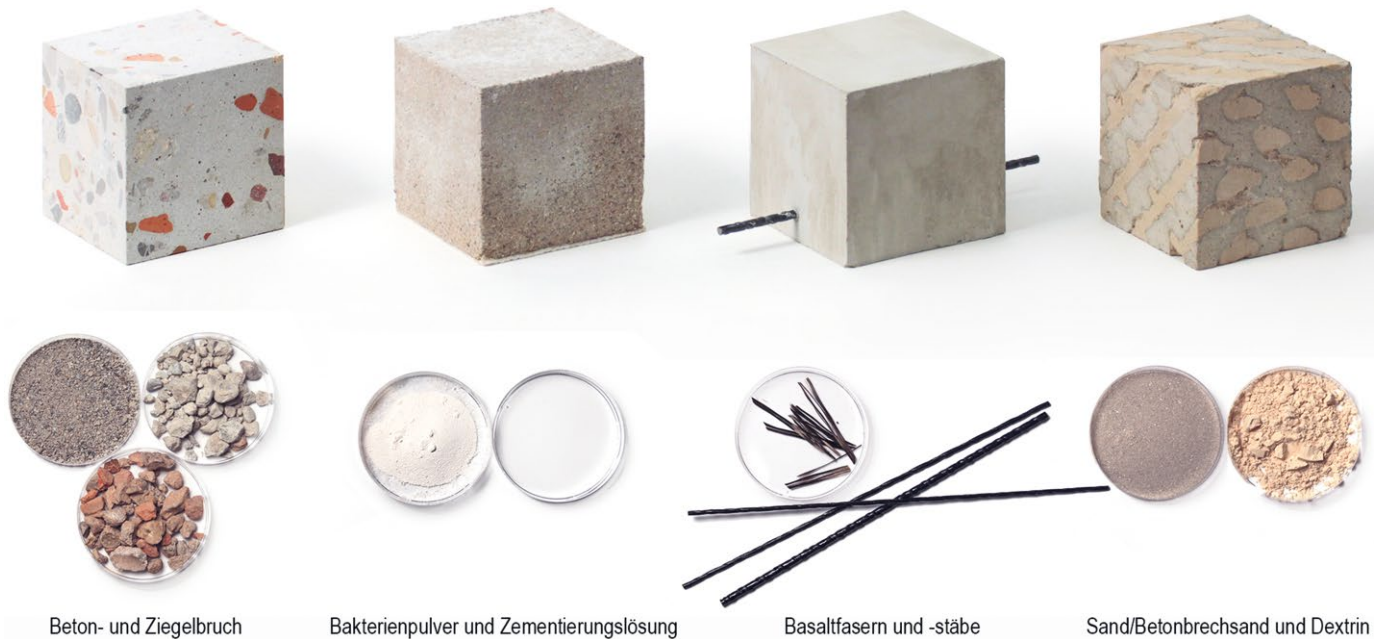
Bild 1 Materialbeispiele und ihre Hauptbestandteile, v.l.n.r.: Betonwürfel mit rezyklierter Gesteinskörnung, Würfel aus Biobeton, Betonwürfel mit Basaltbewehrung, in wasserlösliche Sandschalung gegossener Betonwürfel Material examples and their main constituents, from left to right: concrete cubes with recycled aggregates, cube made of bio-concrete, concrete cube with basalt reinforcement, cube with concrete cast into water-soluble sand formwork
